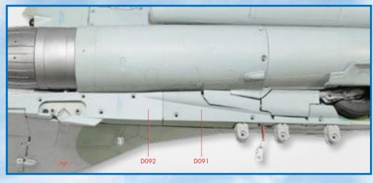
6 Зафиксируйте панель обшивки пятью винтами DM и двумя винтами HM, как показано на снимке.
