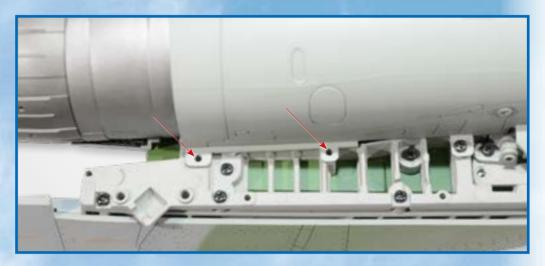
5 Затем установите собранную панель обшивки на фюзеляж модели, как показано на снимке.
